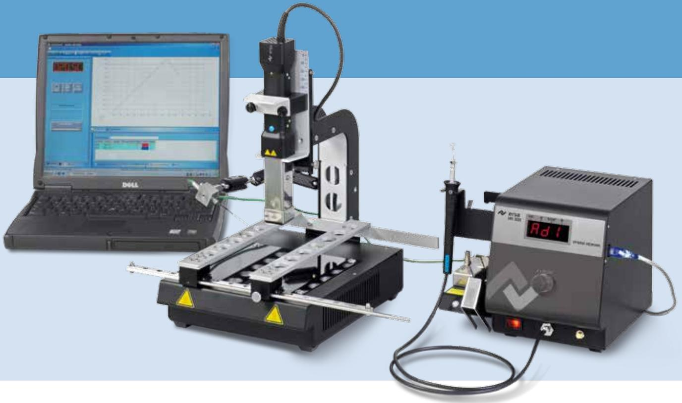
Das HR 100 verwendet Ersas revolutionäre und patentierte Hybrid-Rework-Technologie für ein sicheres Auslöten und Ersetzen von kleinen SMDs. Die mittelwellige IR-Strahlung in Kombination mit einem sanften Heißluftstrahl garantieren eine optimale Energieübertragung auf das Bauteil.
