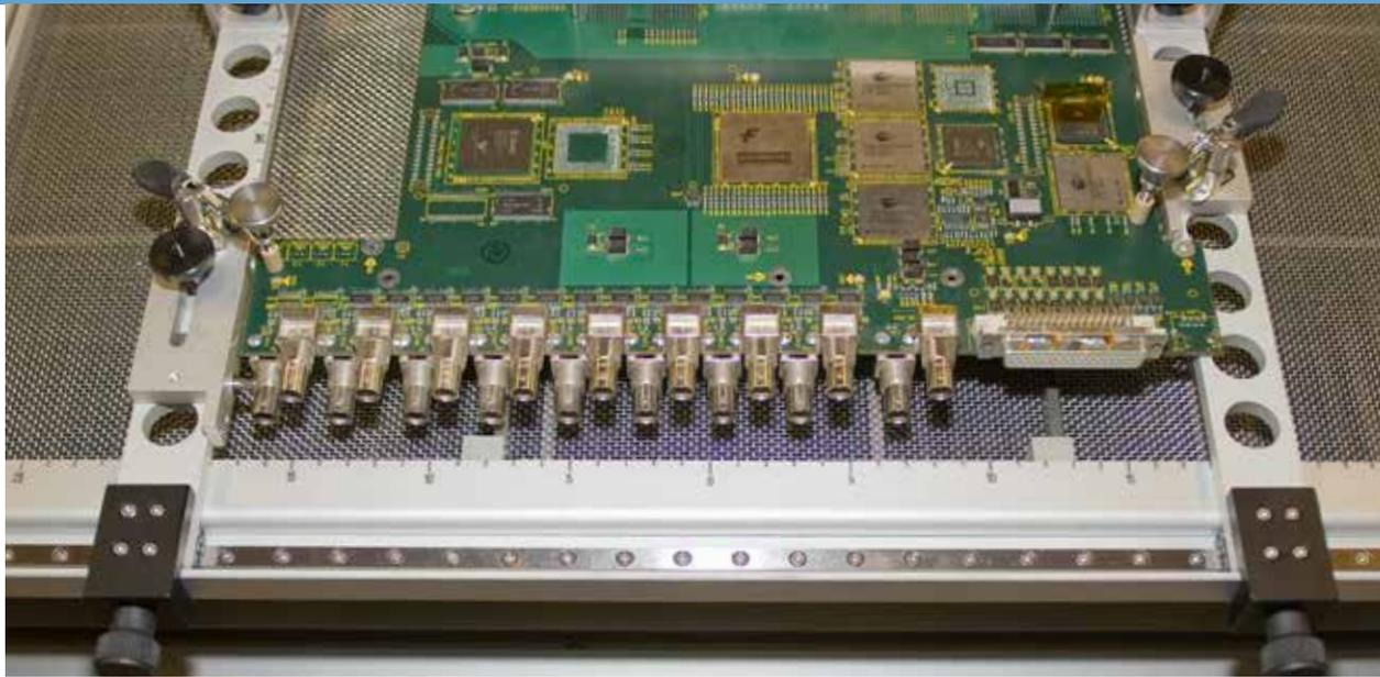
Durch das Design des Leiterplatten-tisches können alle Leiterplatten-geometrien optimal aufgelegt werden. Ober- und unterseitige Stützschi- enen können einfach eingeschoben werden und sind schnell an die jeweilige Rework-Aufgabe anzupassen. Über einen 45°-Klappmechanismus kann der Tisch mit eingespannter Leiter- platte aufgeklappt werden und bietet bequemen Zugang zur Leiterplatten- unterseite. So ist es für den Bediener einfach, Temperaturfühler an der Unterseite anzubringen, Stützpins
