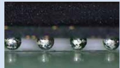
Prozesskamera zeigt das Schmelzen der Lötkekeln
