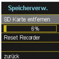
Die Mindestgröße für eine externe Speicherkarte liegt bei einem Gigabyte. Das Gerät kann Speicherkarten bis maximal 32GByte verwalten.
