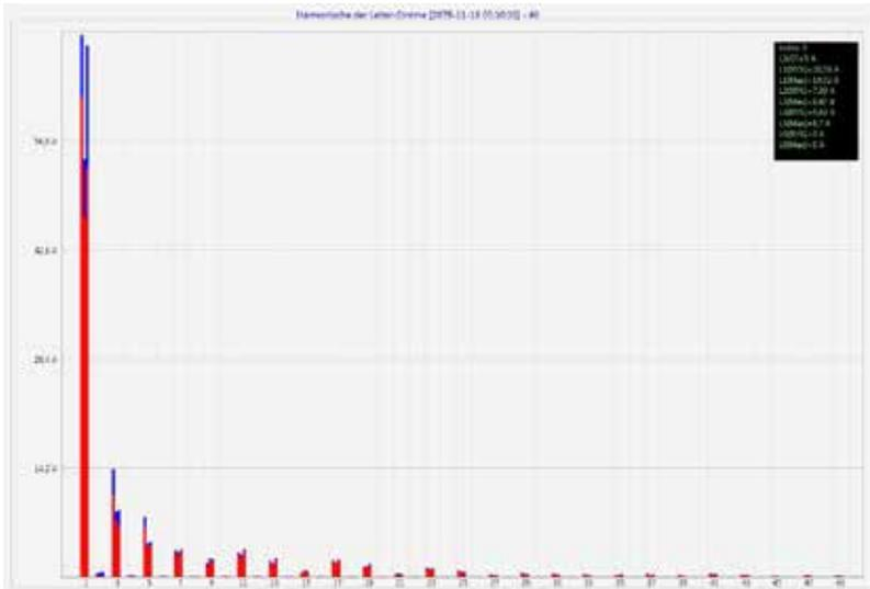
Wählt man mit dem Cursor eine bestimmte Harmonische aus, so werden im Anzeigefeld die entsprechenden Messwerte zu dieser Harmonischen angezeigt.
