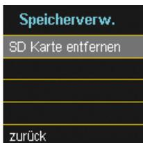
☞ Um die Speicherkarte zu entnehmen Funktion „SD Karte entfernen“ betätigen.
