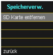
Die Funktion „SD Karte entfernen“ stoppt die Kopierfunktion der Messdaten des internen Speichers auf die SD-Speicherkarte und gibt die Karte frei zum Entfernen.
